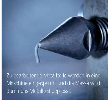
Zu bearbeitende Metallteile werden in eine Maschine eingespannt und die Masse wird durch das Metallteil gepresst.
