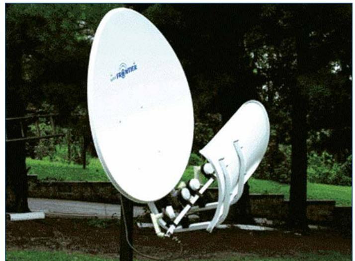
Bild 3.7: Multifeed-Antenne für vier Satelliten
