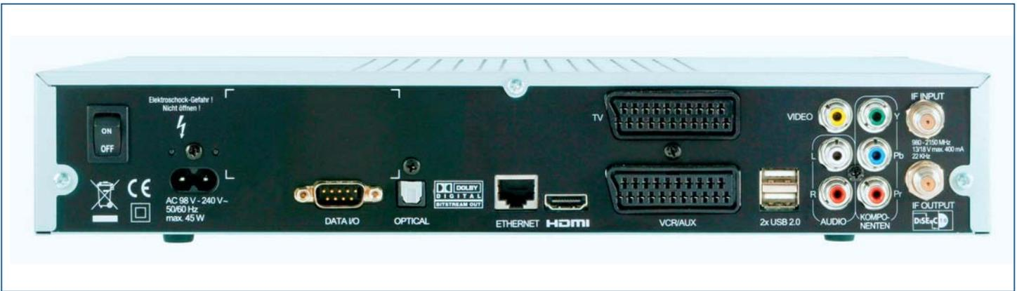
Bild 8.6: Anschlüsse auf der Rückseite einer Set-Top-Box
