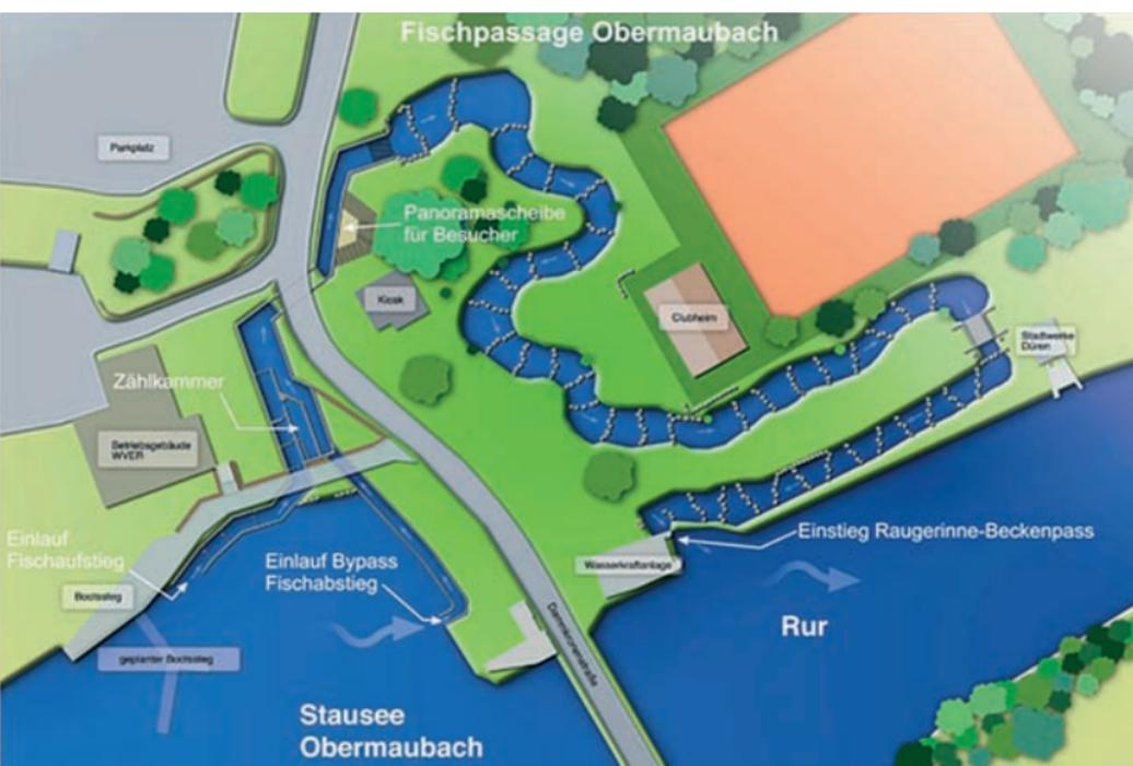
Für die Aufwärtswanderung wurde der Einstieg für die Fische auf dem linken Ufer nahe der Wasserkraftanlage platziert, um die Lockströmung maximal auszunutzen. Das Einlaufbauwerk in den See wurde so konstruiert, dass der Aufstieg der Tiere und ein konstanter Abfluss im Fischaufstieg bei jedem Seewasserstand sichergestellt sind.
