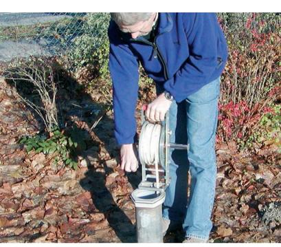
Grundwassermessung mit Lichtlot
