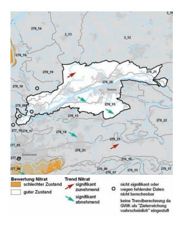
Die Abbildung zeigt die Bewertung der Monitoringergebnisse für den Parameter Nitrat. Danach wurde im Grundwasserkörper 19 ein signifikant zunehmender Trend bei der Nitratbelastung festgestellt. Auch hier sind weitere Untersuchungen und Kontrollen durchzuführen.
