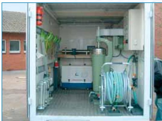
Abb. 06 Zentrifuge im Probenahmefahrzeug
