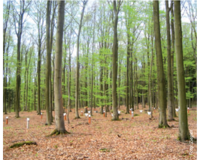
Niederschlagsammler und Streifalltrichter auf der Dauerbeobachtungsfläche 507 in der Eifel
