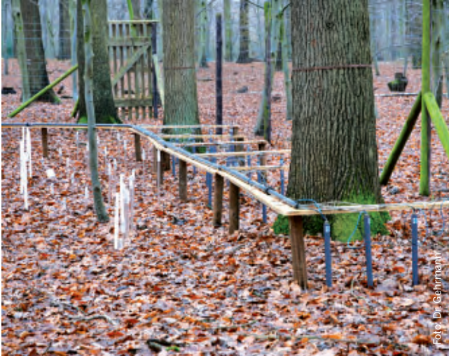
In Kleve/Tannenbusch wird die Bodenwasserspannung mit elektronischen (rechts) und manuellen (links) Tensiometern gemessen
