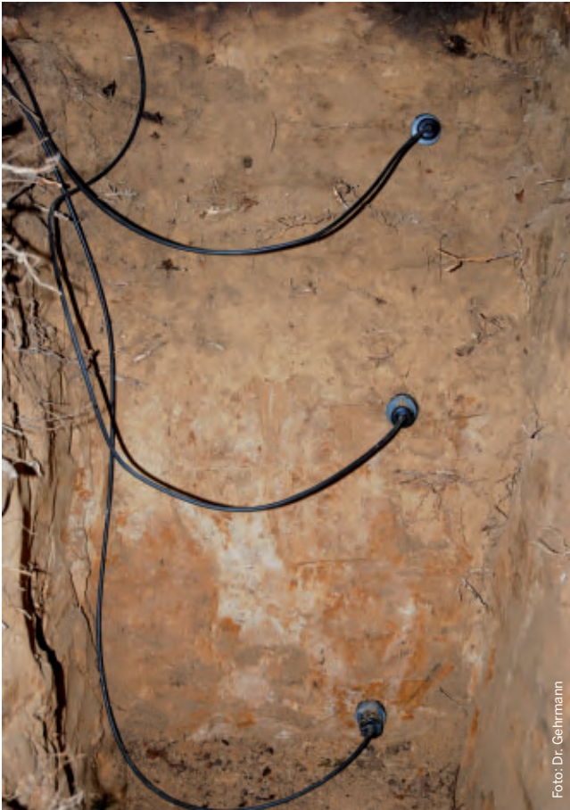
Unter den Eichen in Kleve/Tannenbusch werden Bodenfeuchtesonden in den Tiefen 20 cm, 60 cm und 100 cm eingesetzt
