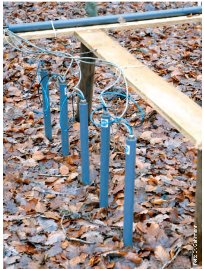
Elektronische Tensiometer registrieren die Wasserspannung unter den Eichen in fünf Bodentiefen
