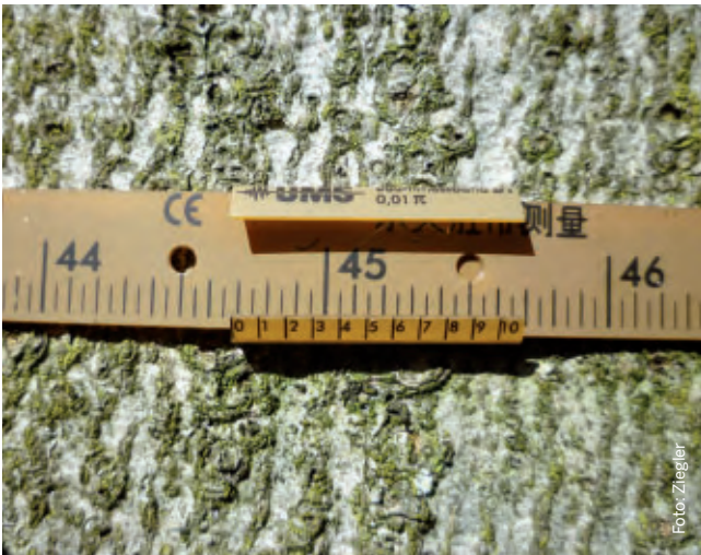
Dauermessbänder ermöglichen Zuwachsmessungen mit einer Genauigkeit von 1/10 mm
