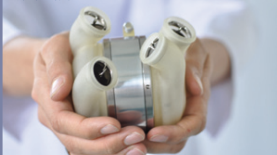
Beispiel eines voll implantierbaren Kunstherzens – Das ReinHeart
