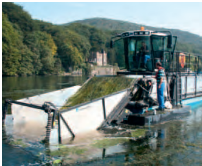
Bild 13.11: Mäh-Sammelschiff „Manati“ auf dem Hengsteysee Fig. 13.11: Mowing boat „Manati“ on Lake Harkort
