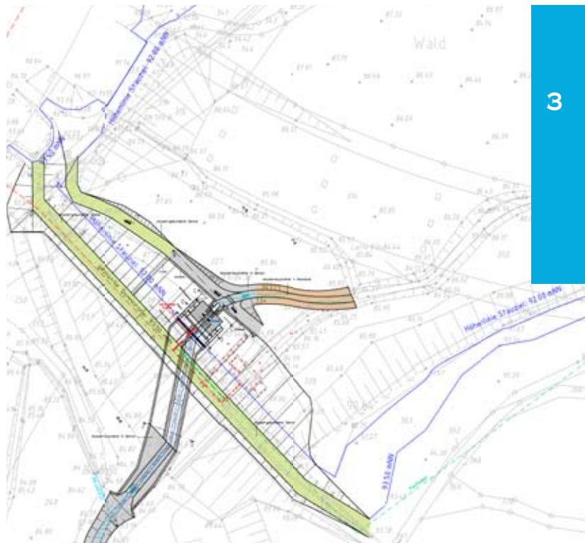
Planung Hochwasserrückhaltebecken Viehbach
