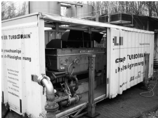
**Versuchseindickmaschine auf der
