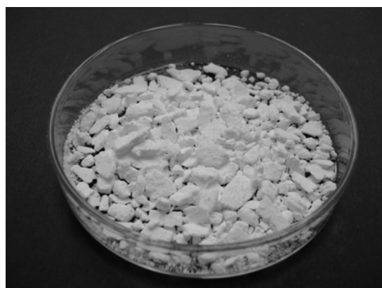
Siliciumdioxid – Ablagerungen aus der Heizanlage der Kläranlage Dülken
