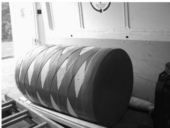
„Reinigungsmolch“ vor dem Einsatz und nach der Reinigung am Rohrleitungsende auf dem KW Grefrath
