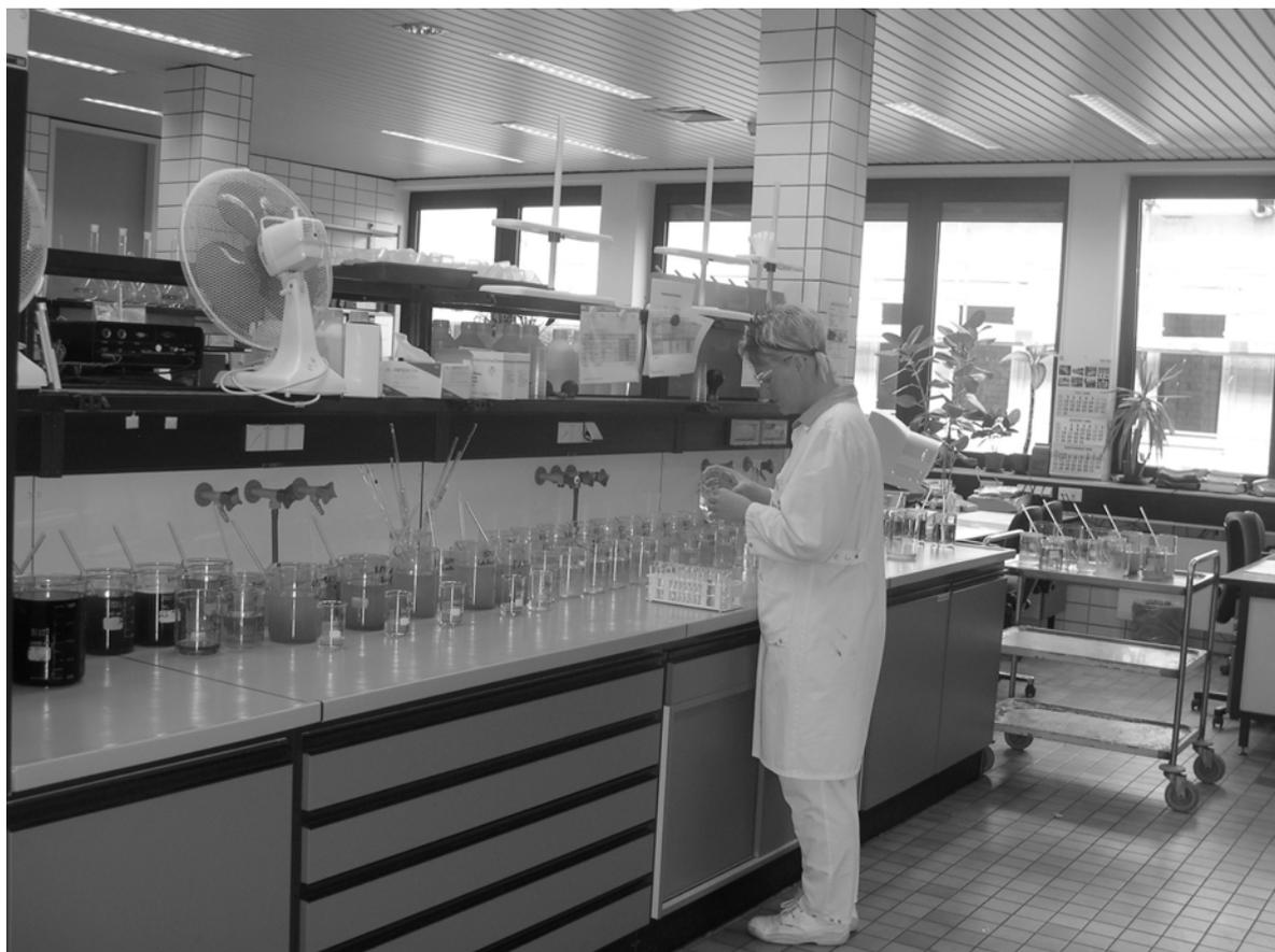
**Sonja Engels bei der Abnahme von Teilproben zur Ammonium- und Phosphatbestimmung**
