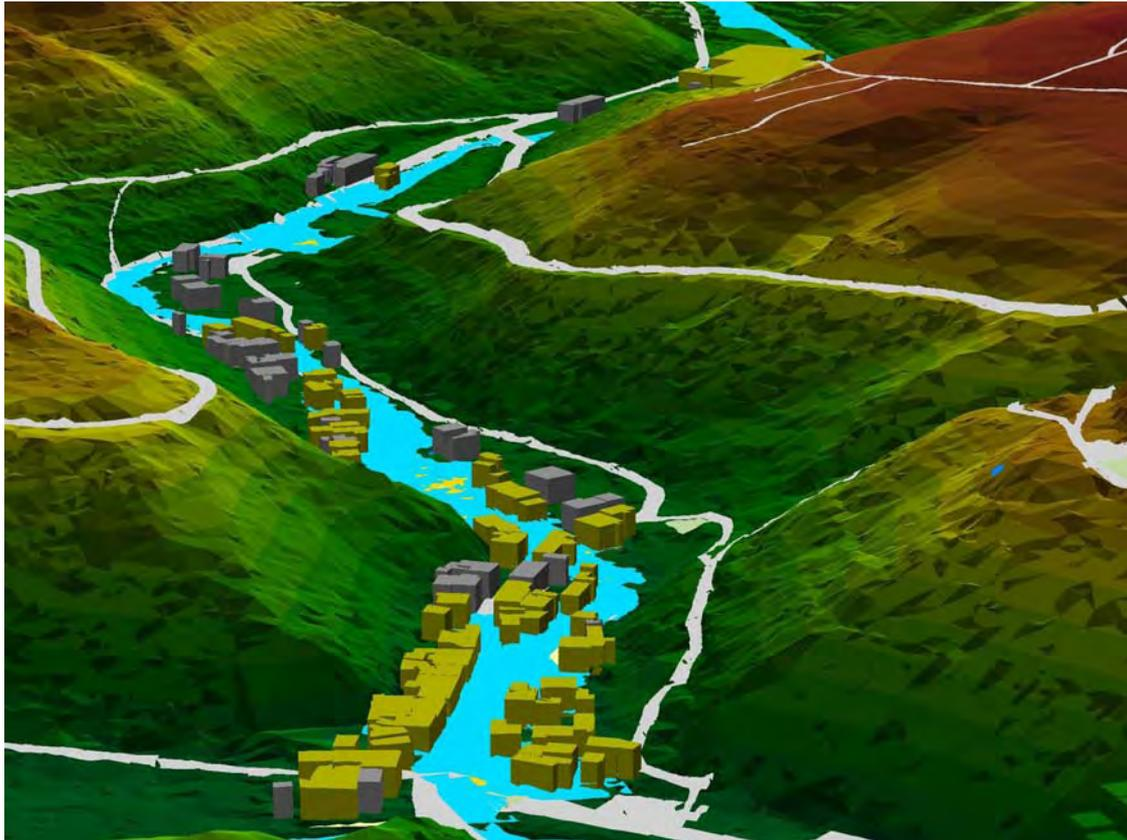
Abbildung 25: Darstellung hydraulischer Ergebnisse in einem 3-D-Modell
