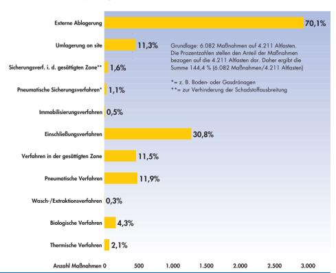
Anwendung von Sanierungsverfahren bei Altlasten in NRW (Stand 31.01.2006)
