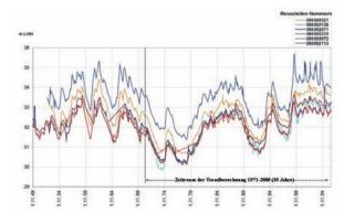
Zeitreihen von Grundwasserständen ausgewählter Messstellen für 1949 - 2004 Abbildung 5.4-1
