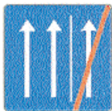
Zeichen 223.2, Seitenstreifen nicht mehr befahren
