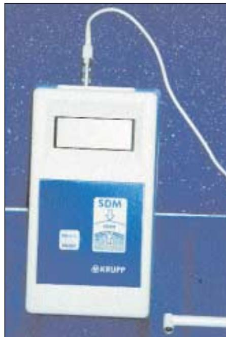
Abb. 1: SDM®-Gerät der Firma Krupp (A-Scan).
