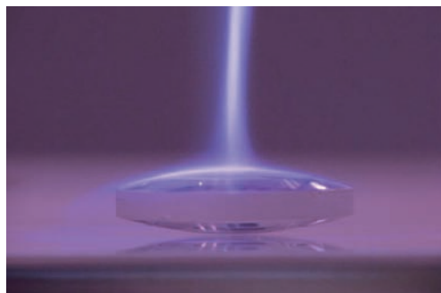
Behandlung einer Linse mittels eines Argon-Plasmajets.
