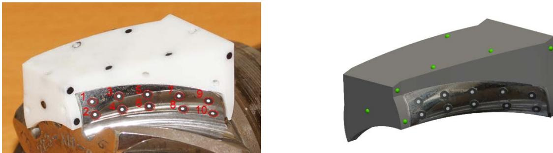
Bild 6: Messaufnahme (links), texturierte Zahnflanke mit virtueller Messschablone (rechts)
