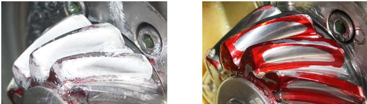
Bild 8: Tragbildprüfung am Ritzel, Tuschiertragbild (links), Lasttragbild (rechts)
