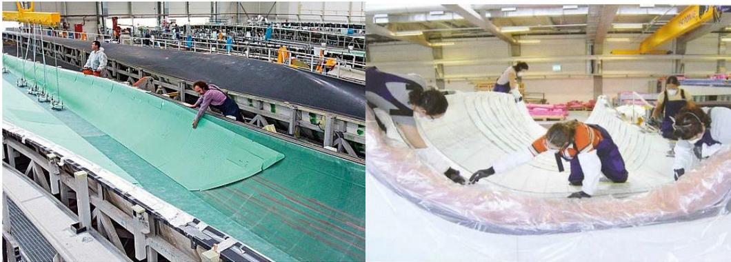
Abbildung 4: Manuelles einlegen des Kernmaterials (links) und des Glasfasergeleges (rechts)
