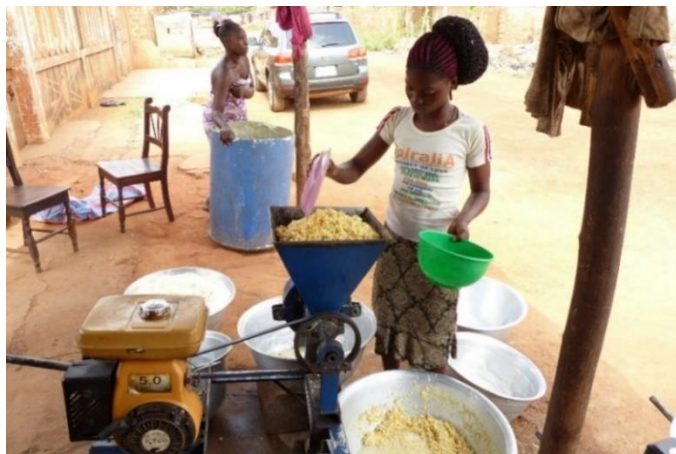
Abb. 15: Mahlen der am Vorabend eingeweichten Bohnen mit einer Motormühle
