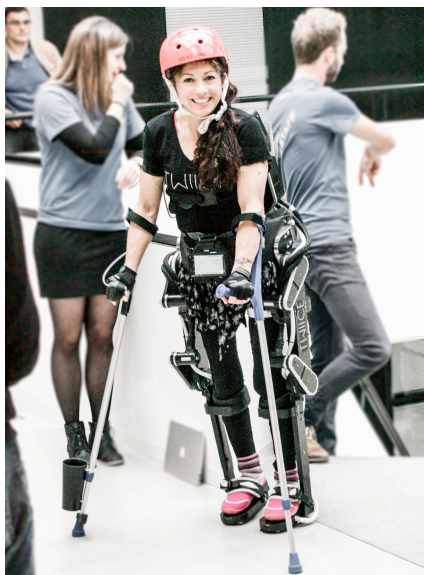
Bild: Silke Pan mit dem Exoskelett TWIICE [7]
