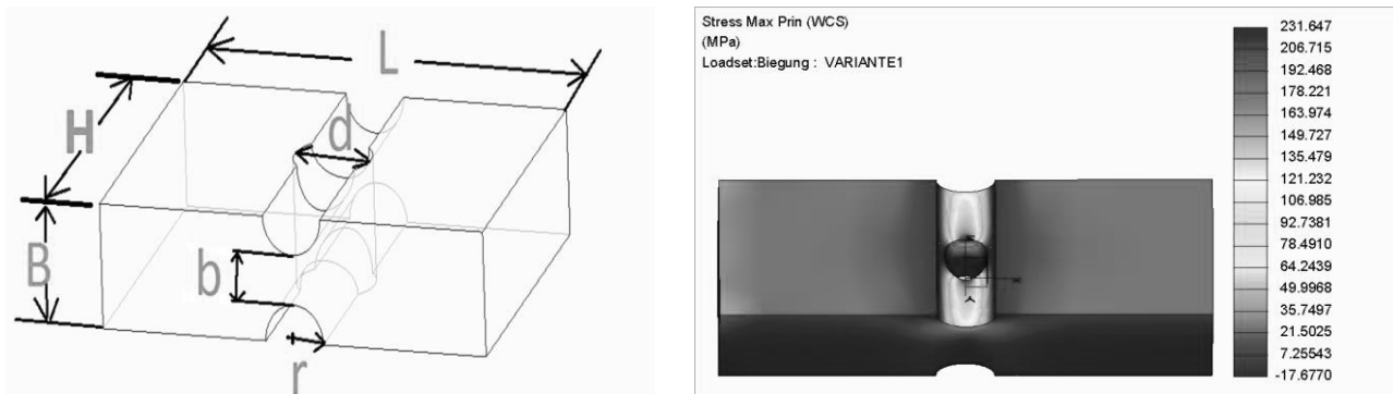
Bild 2: Berechnungsmodell eines zugbelasteten Stab mit beiderseitiger Halbkreisnut und zusätzlicher Querbohrung (links), und Spannungsverteilung nach der NSH (rechts)
