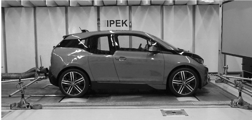
Bild 1: Fahrzeug mit Fahrerassistenzsystemen auf dem Rollenprüfstand
