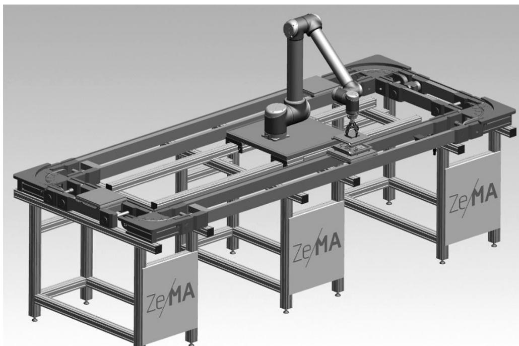
Bild 2: Ansicht Arbeitsstation mit vormontiertem Greiferwerkzeug
