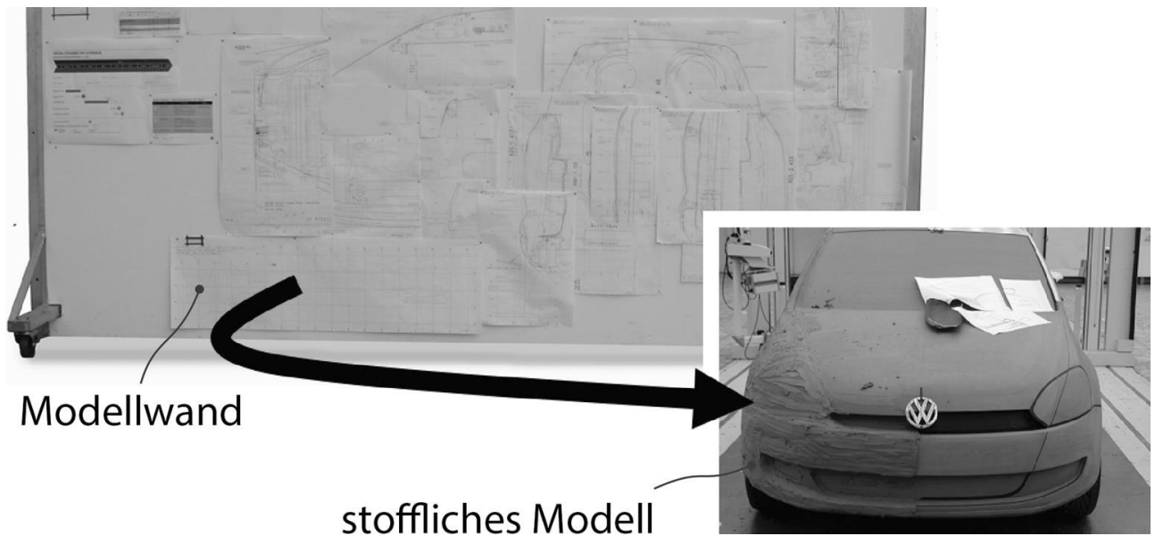
Bild 3: Schnittansichten an einer Modellwand und das stoffliche Designmodell
