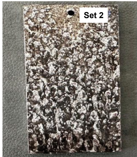
Abb. 4: Aufnahmen nach Korrosionstest von SET 2 der 7075-Legierung nach 120 Stunden
