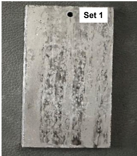
Abb. 2: Aufnahmen nach Korrosionstest von SET 1 der 7075-Legierung nach 120 Stunden
