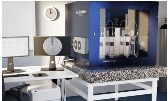
Abb. 2: Tribologischer Prüfstand zur Messung der tribologischen und elektrischen Eigenschaften der Schichtaufbauten
