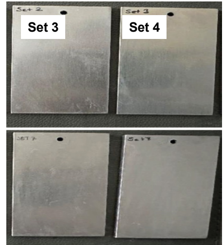
Abb. 5: Aufnahmen nach Korrosionstest 240 Stunden und 480 Stunden von SET 3-4 der 7075-Legierungen
