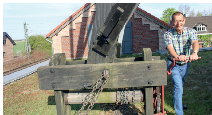
Frank Quidies an der Kurbel auf dem Mühlenberg, mit deren Hilfe die tonnenschwere Mühlenkappe von nur einer Person gedreht werden kann.
