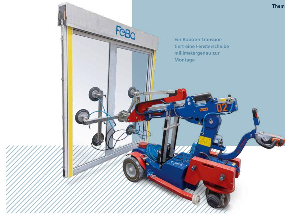
Ein Roboter transportiert eine Fensterscheibe millimetergenau zur Montage
