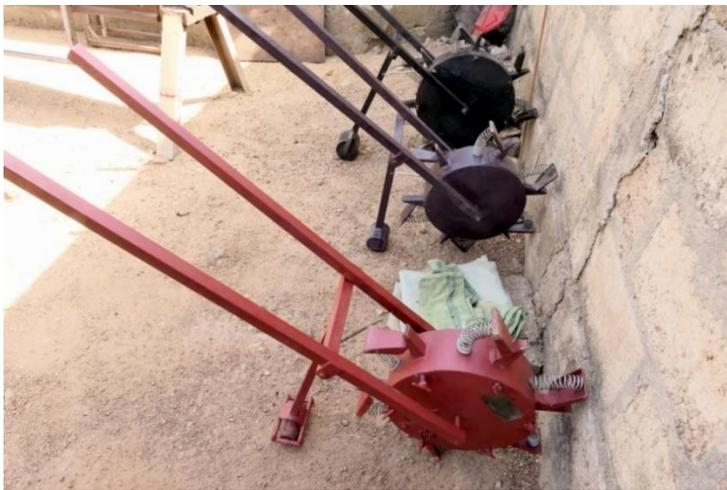
**Abb. 11 Einfache Sämaschinen**
