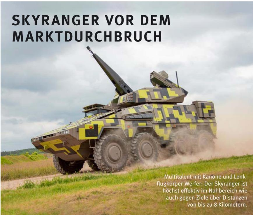
Multitalent mit Kanone und Lenkflugkörper-Werfer: Der Skyranger ist höchst effektiv im Nahbereich wie auch gegen Ziele über Distanzen von bis zu 8 Kilometern.
