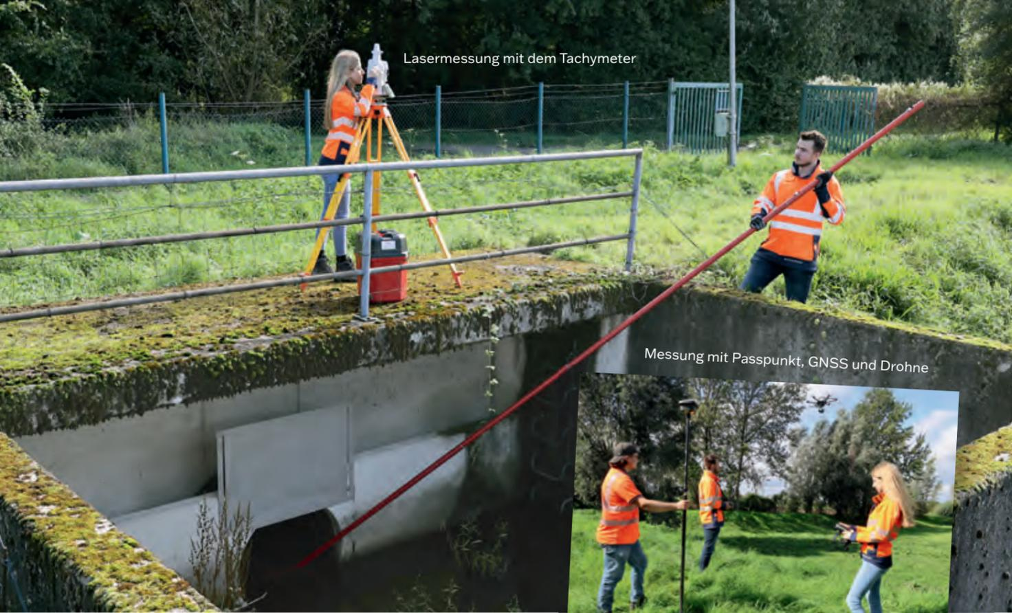
Lasermessung mit dem Tachymeter
