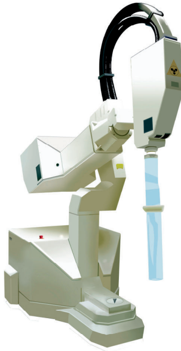
Abb. 4: Linearbeschleuniger für die intraoperative Strahlentherapie in der Universitätsfrauenklinik
