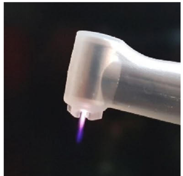
Abb. 2 (unten): Fotografie des Plasmageräts (links) und des Plasmakopfs mit der sichtbaren kalten Flamme (rechts), mit der in rauen Implantatstruktur verbliebene Mikroorganismen inaktiviert werden und die Titanoberfläche hydrophilisiert wird.
