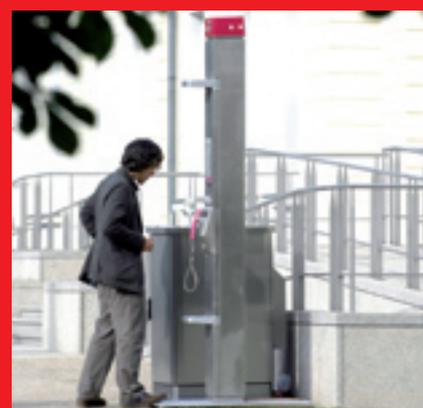
**Brennstoffzellenbetriebene Telefonsäule aus dem Hause T-Com**
