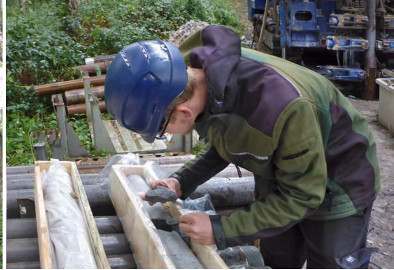
Begutachtung der Bohrkern
