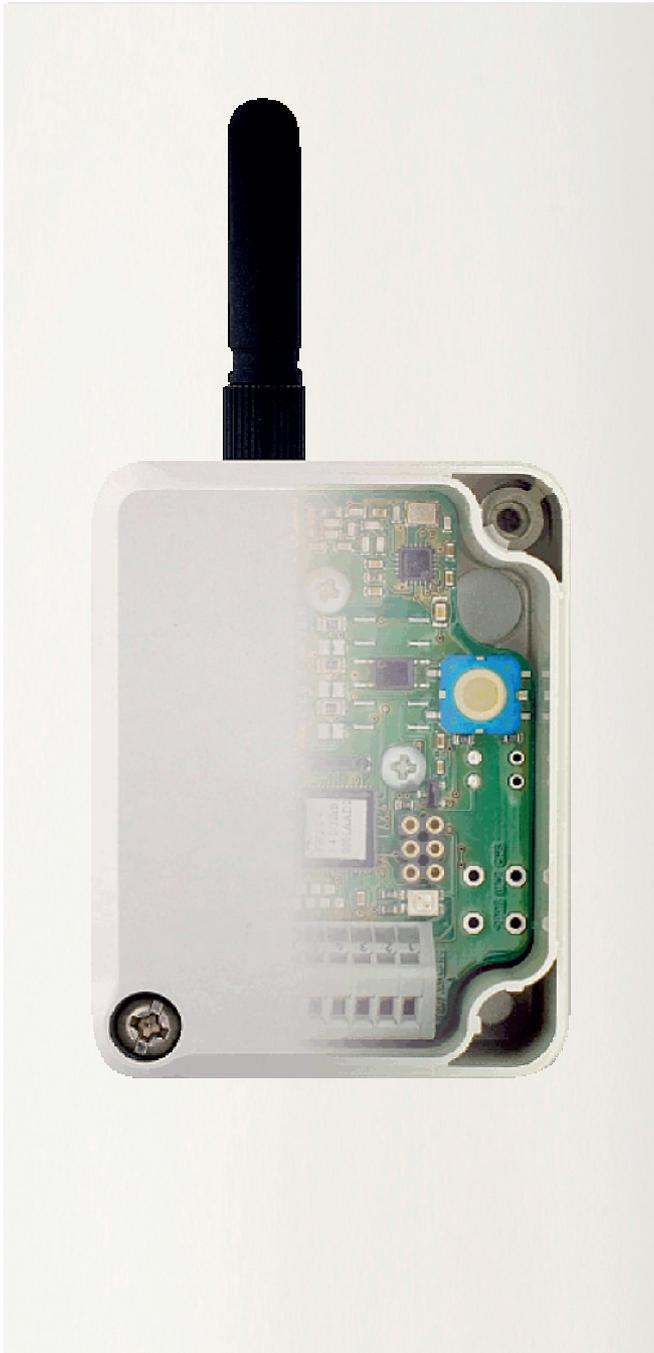
Das Funkmodul ergänzt die batteriebetriebenen elektronischen Schließzylinder und Türbeschläge von IntraKey mit online-Funktionalitäten eines Zutrittskontrollsystems, jedoch ohne aufwändige Verkabelung.
