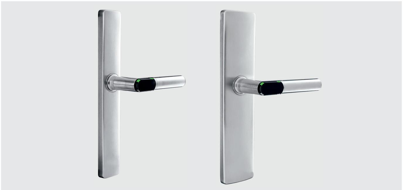
Der Türbeschlag IK CX6174 mit einseitiger elektronischer Berechtigung ist eine vielseitig einsetzbare, batteriebetriebene Schließeinheit. Die elektronische Leseinheit befindet sich auf der Außenseite und ein mechanisch festgekoppelter Innendrucker auf der Innenseite.
