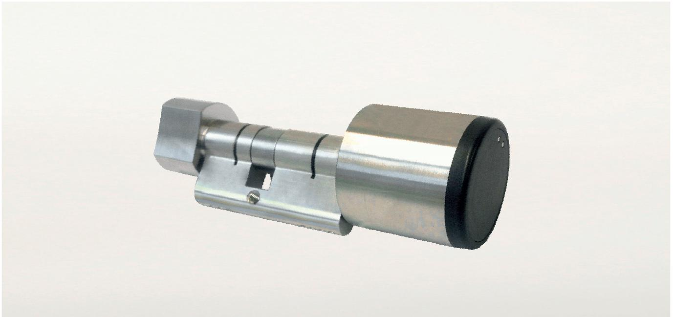
Der elektronische Doppelknäufzylinder ist eine vielseitig einsetzbare, batteriebetriebene Schließeinheit mit elektronisch einkuppelbarem Knäuf auf einer Seite und einem mechanisch fest verbundenen Drehknäuf auf der anderen Seite.
