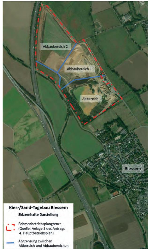
**Bild 14.1** – Darstellung des Tagebaus Blessem (genehmigte Abbaugrenze (rot), Unterteilung in Altbereich und Abbaubereiche 1 u. 2 (blau)) (Quelle: Bericht des Ministeriums für Wirtschaft, Innovation, Digitalisierung und Energie des Landes Nordrhein-Westfalen vom 1. September 2021 an den Landtag Nordrhein-Westfalen (Vorlage 17/5646))
