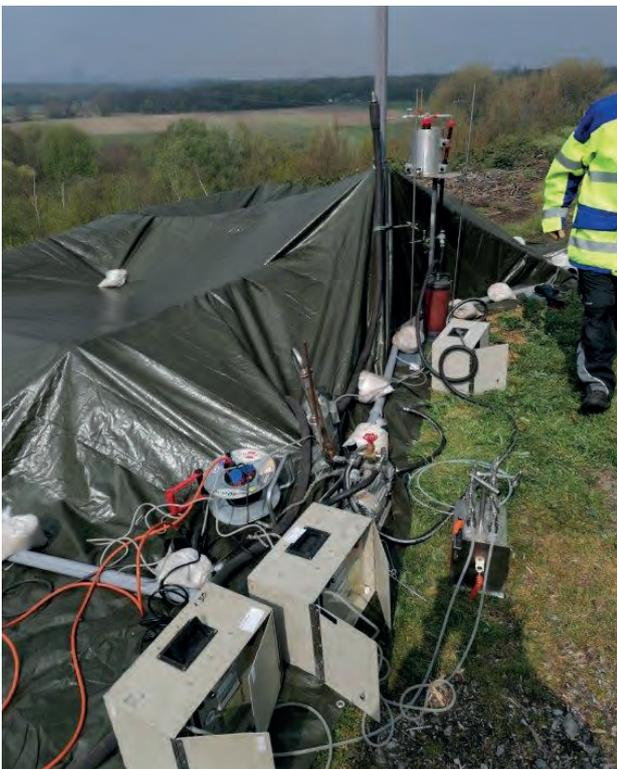
**Bild 9.13** – Anordnung der Emissions-Messstelle mit Speichertechnik
