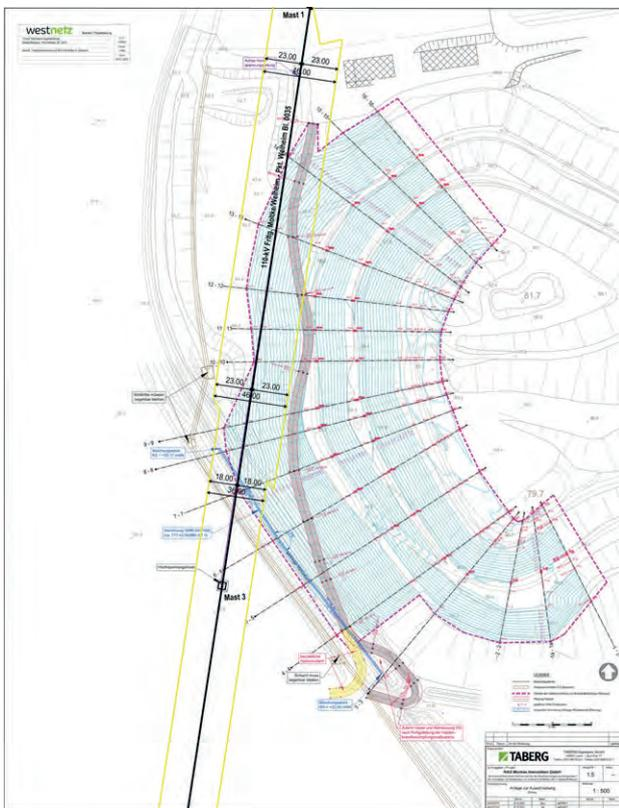
**Bild 9.9** – Übererdungsbereich (hellblau) mit Darstellung Sicherheitsbereich Hochspannungsleitung
