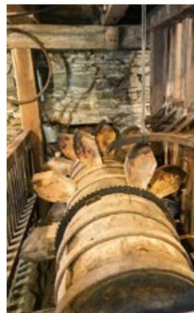
Die vom Wasserrad angetriebene Daumenwelle (rechtes Bild) sorgt dafür, dass die hölzernen Stempel des Stampfwerks (Mitte) angehoben werden und beim anschließenden Herabfallen die in der Mulde liegenden Knochen zerkleinern.
