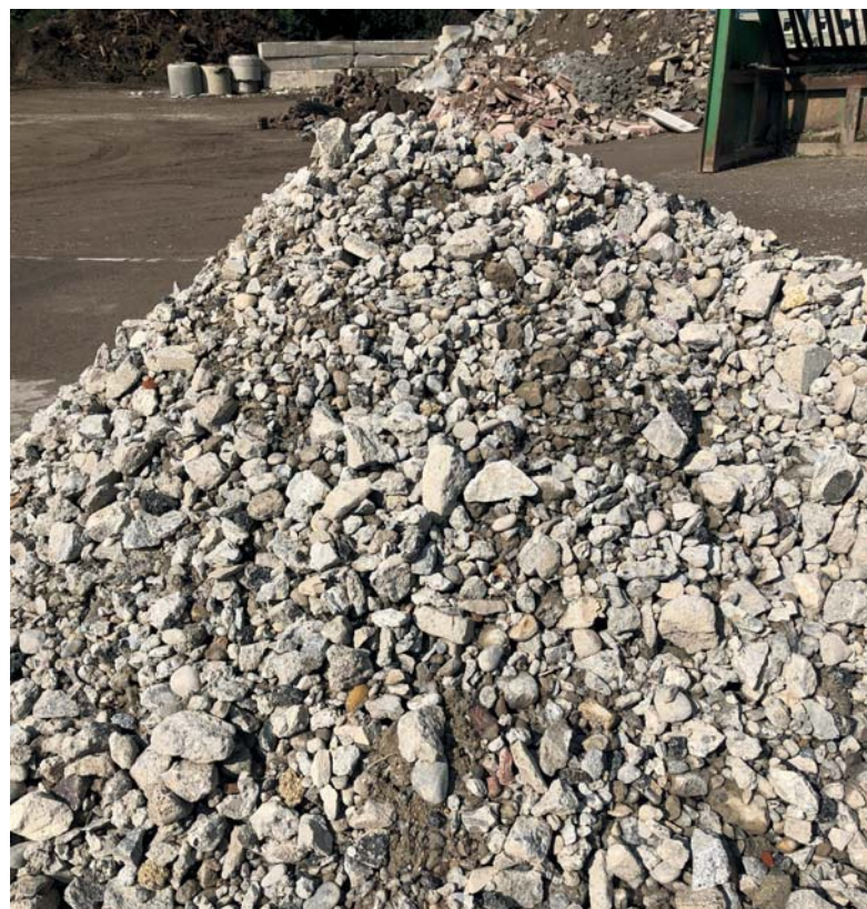
Separat gesammelter mineralischer Bauschutt lässt sich zu Recyclingbaustoffen aufbereiten. Foto: MIRO
