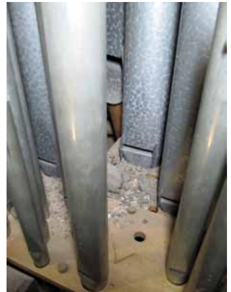
Blick in das Pedalwerk mit Hintersatz (oben) und in das Hauptwerk mit Offenflöte 8' (unten); starke Verschmutzung und Beschädigung der Pfeifen – die Rohrflöte 8' ist nicht spielbar.
