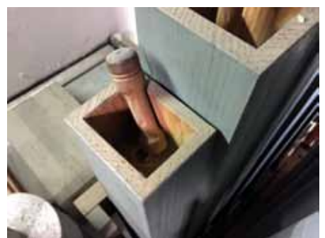
Blick in das Oberwerk mit abgebrochener Stimmvorrichtung
