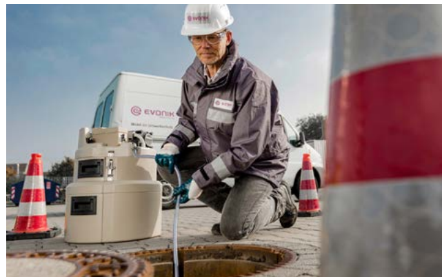
Prozessabwässer, die bei der Produktion entstehen, werden an den Standorten regelmäßig analysiert. Dazu werden Proben entnommen.
