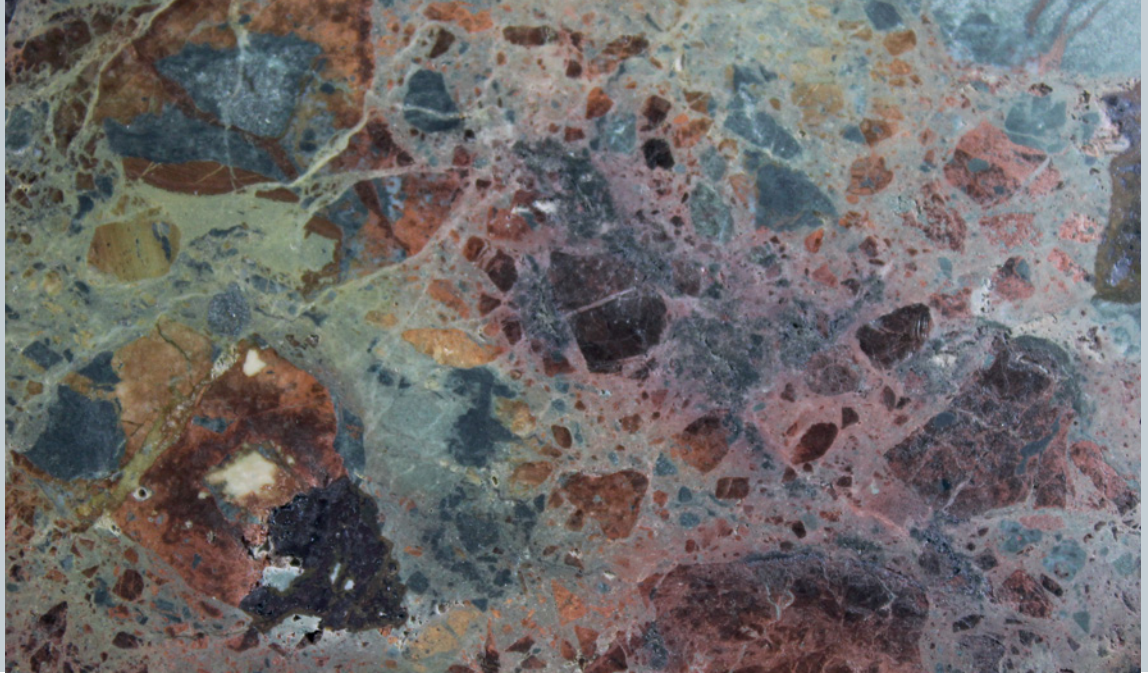
Abb. 5: Brekziertes Siderit I, hell bis dunkel rotbraun, und Nebengesteinsbruchstücke (grüngrau), verheilt durch jüngeren, feinkörnigen Quarz; Bilsteiner Berg, polierter Anschlag, lange Bildkante 3 cm
