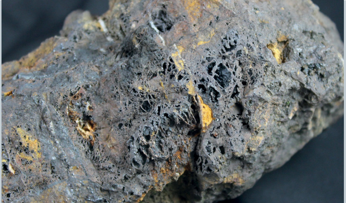
Abb. 2: Brauneisen mit Glaskopfstruktur aus dem Ausgehenden des Siderit-Ganges. Gut erkennbar ist die typische kavernöse Struktur infolge Volumenverminderung bei der Umwandlung des Siderits in Brauneisen (vgl. auch Abb. 6). Bilsteiner Berg, lange Bildkante 6 cm.
