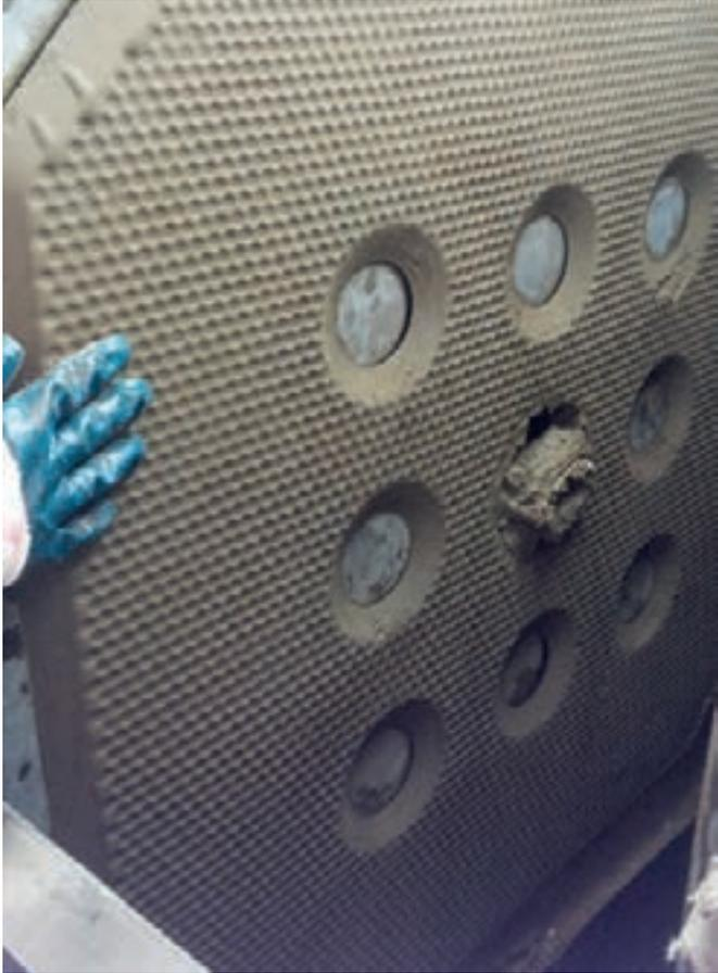
Bild 19.3: Auswurf Filterkuchen, Konditionierung mit Kartoffelstärke (340 gWS/m<sup>3</sup>)
