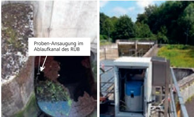
Bild 10.1: Ereignisbezogene Probenahme in der Entlastung eines der beprobten Regenüberlaufbecken (RÜB)
