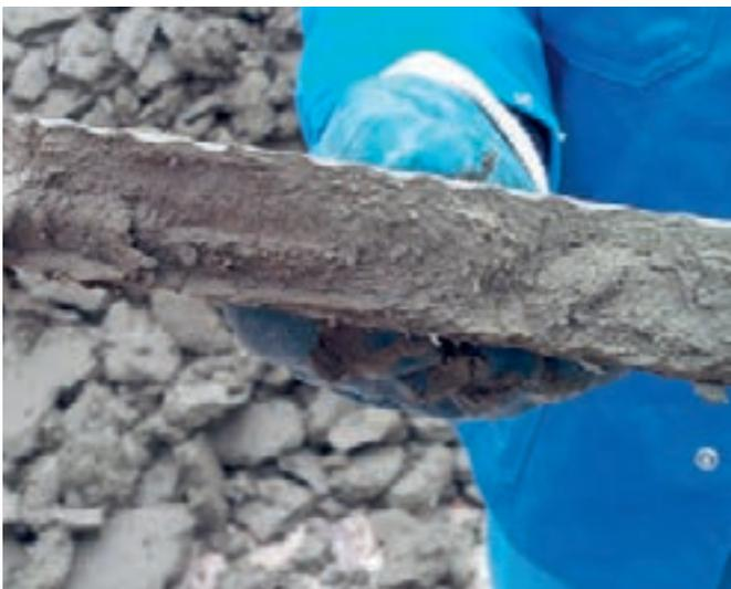
Bild 19.4: Filterkuchen, Konditionierung mit Kartoffelstärke (340 gWS/m<sup>3</sup>)
