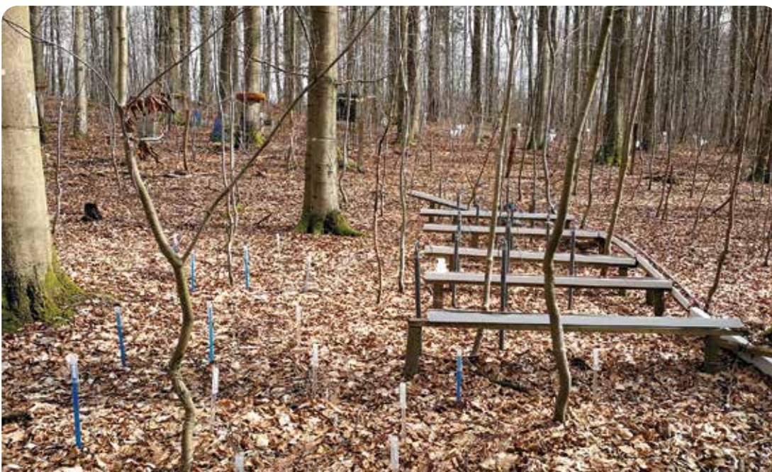
Messung der Bodenwasserspannung mit Tensiometern auf der Level-II-Fläche Schwaney
