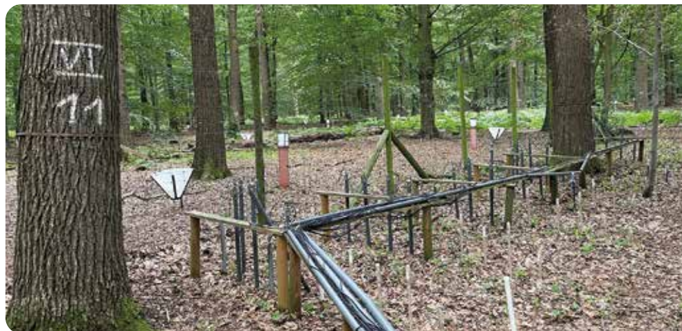
Messung der Bodenwasserspannung mit Tensiometern auf der Level-II-Fläche Kieve-Tannenbusch
