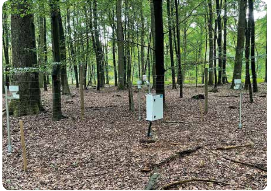
Bodenfeuchtemessstation des Geologischen Dienstes auf einer Dauerbeobachtungsfläche des forstlichen Umweltmonitorings (Viersen)
