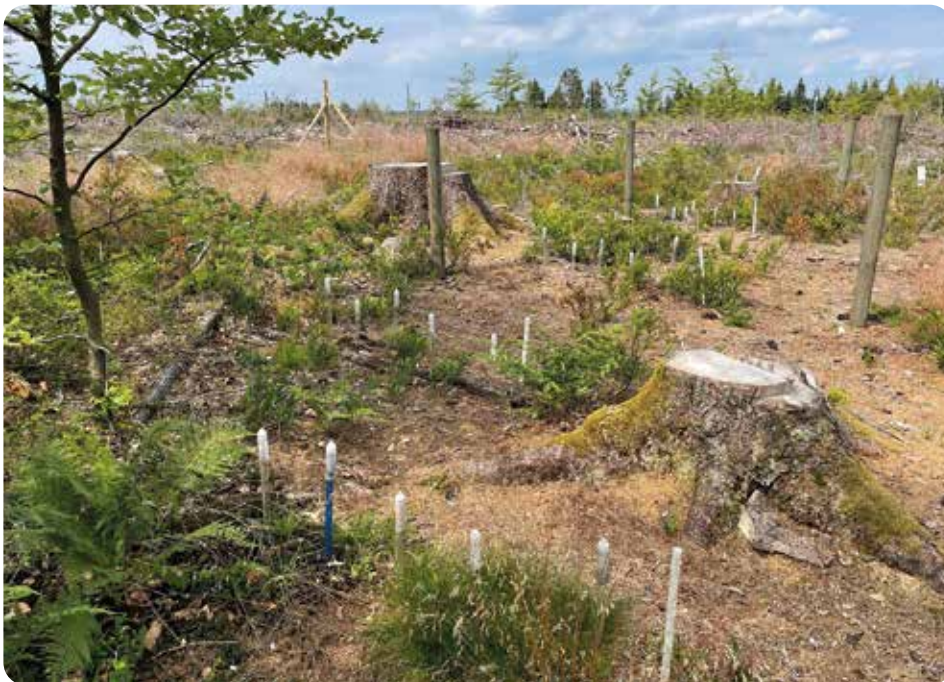
Messung der Bodenwasserspannung mit manuellen Tensiometern auf der Kalamitäts-Level-II-Fläche Elberndorf
