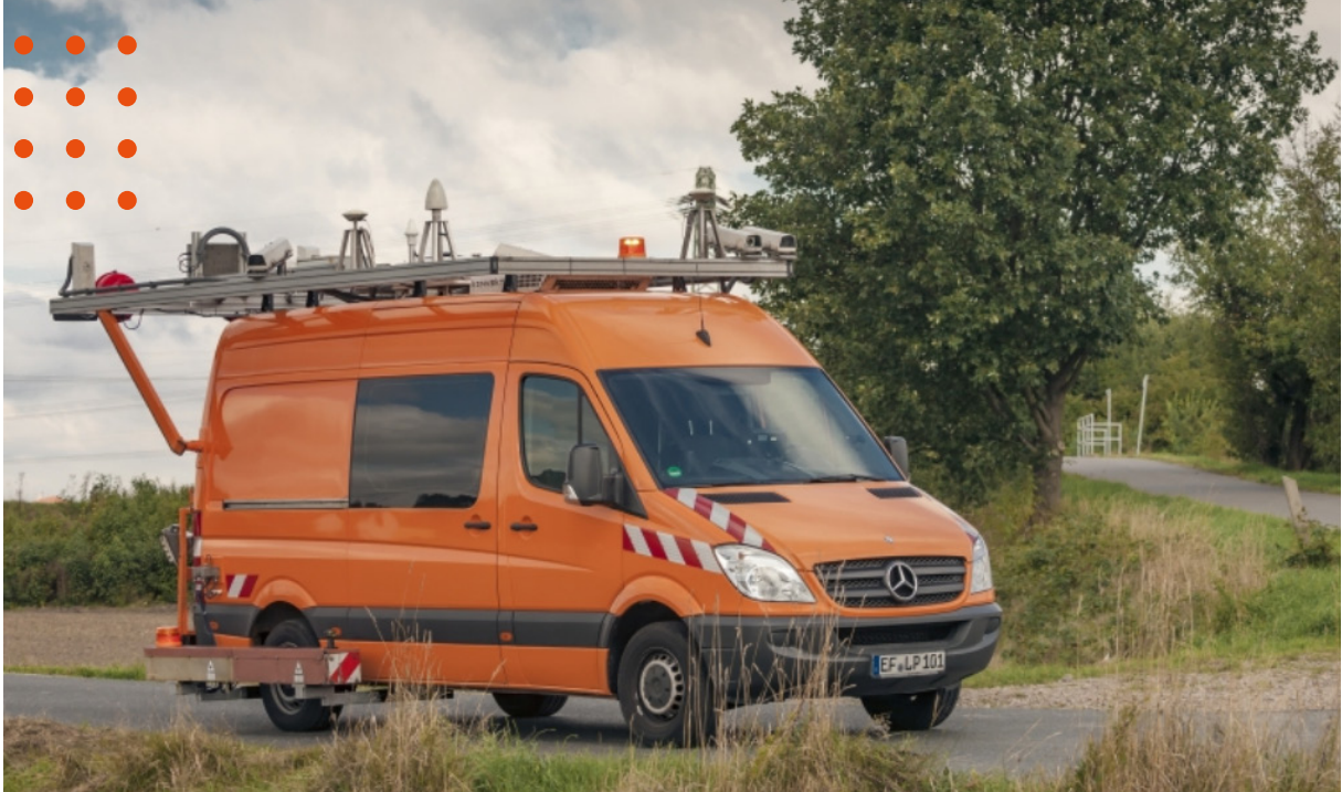
Fahrzeug für die gemeinsame Straßenzustandsbefahrung in Nörvenich, Aldenhoven und Nideggen; Quelle: Lehmann & Partner
