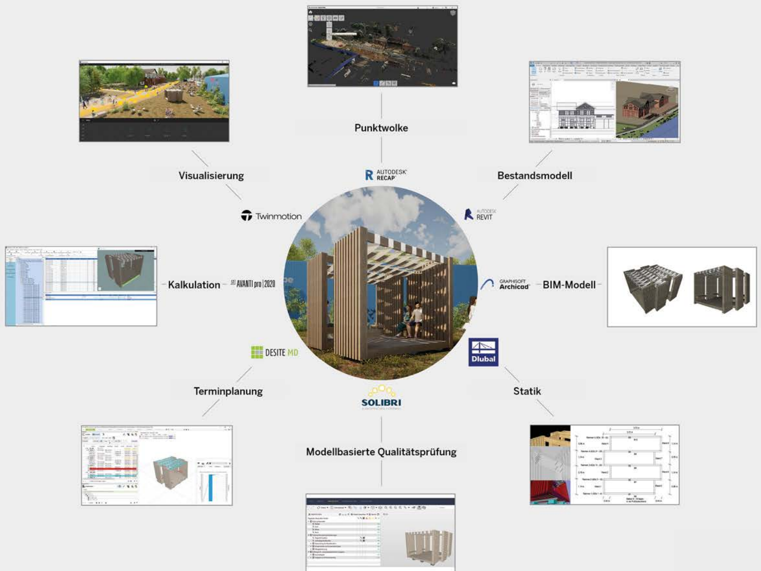
Die Abbildungen zeigen die Ergebnisse des Gewinnerteams der BIM-Summer School 2020. Die Studierenden erstellten die BIM-Modelle zu einem Pavillon, der auf der Nordbahntrasse in Wuppertal realisiert werden soll.
