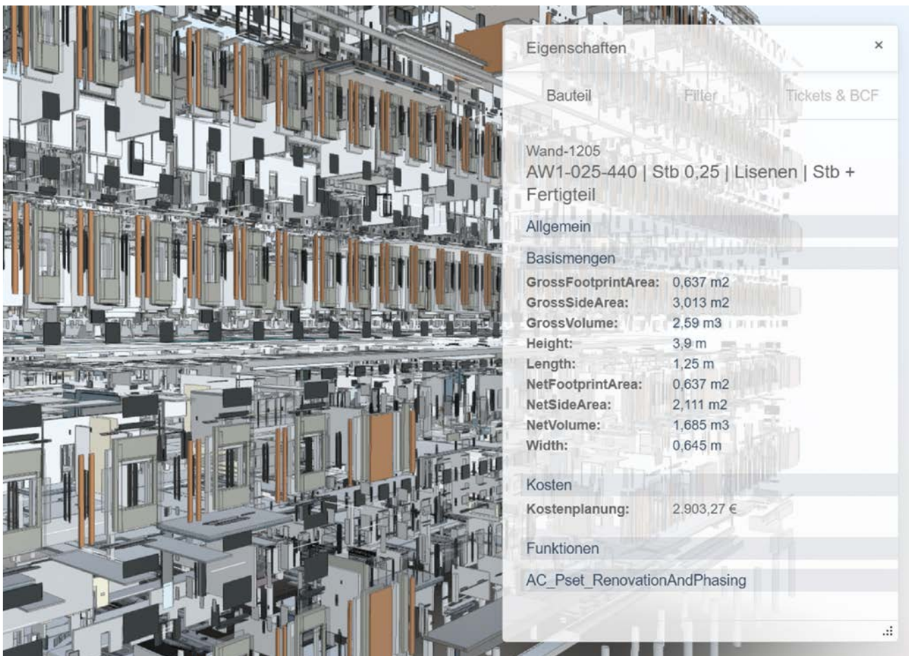
Cloudbasiertes BIM-Modell. Die Modelle helfen bei der Kostenkontrolle in der Architekturplanung. Erstellung und Handling sind Teil des Architekturstudiums an der HSD. Bild oben: Darstellung des gesamten Gebäudes. Bild unten: Detaillierte Darstellung eines Bauteils, Fassade.
