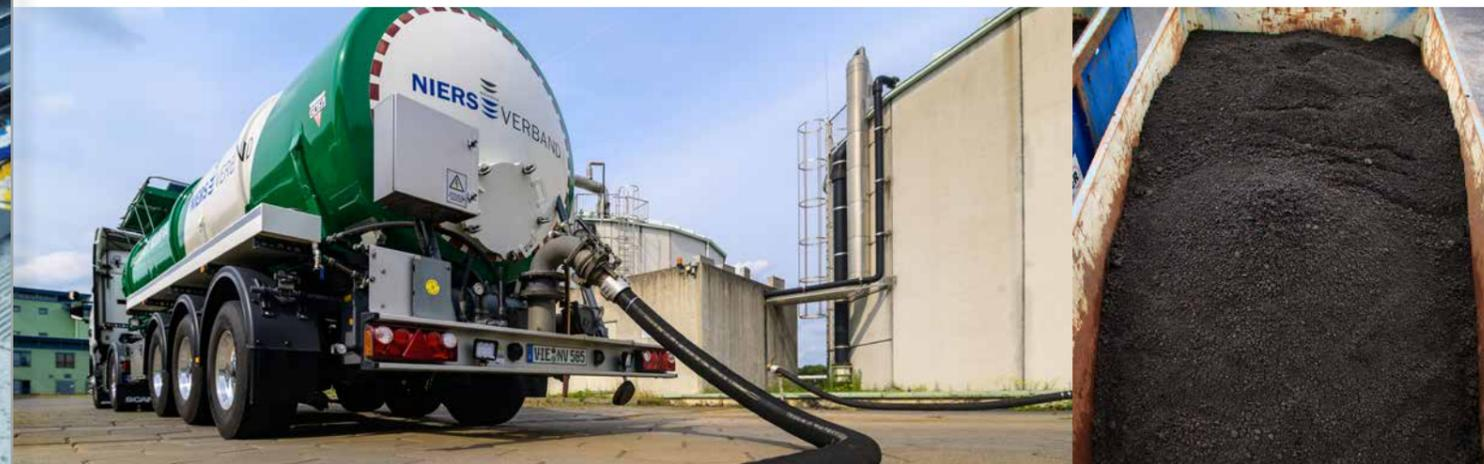
Der bei der Reinigung entstehende Klärschlamm muss täglich entsorgt werden.
