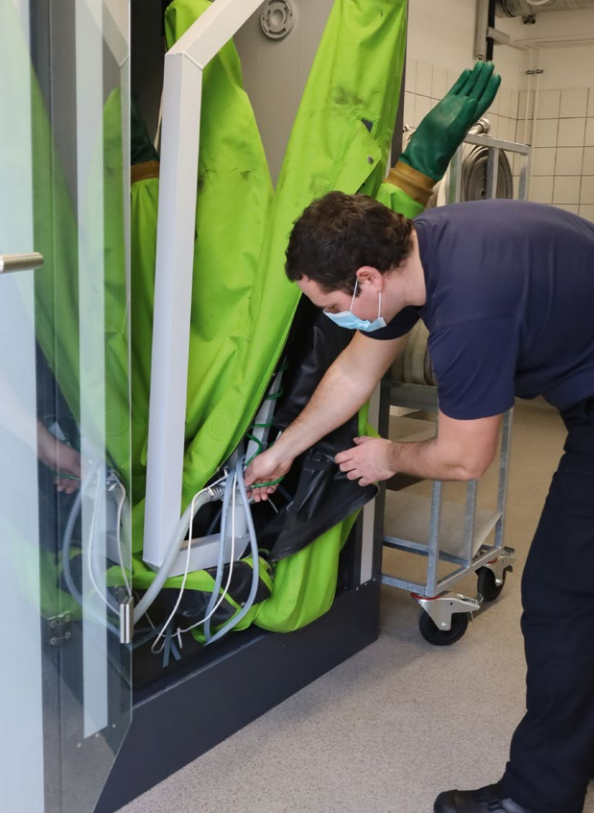
Für die Reinigung von kontaminierten Schutzmonturen steht den Feuerwehrleuten nun eine spezielle Waschanlage zur Verfügung.
