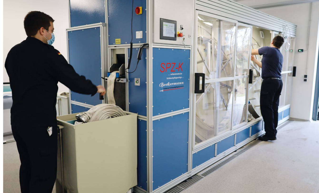
Früher mussten die Schläuche per Hand gewaschen werden. Jetzt übernimmt eine moderne Schlauchpflegemaschine die Arbeit.
