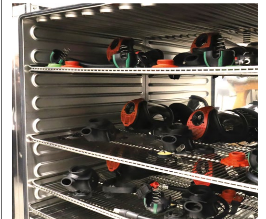
Die Atemschutzwerkstatt ist mit einem Sterilisator ausgestattet, in dem die demontierten Atemschutzgeräte in Einzelteilen regelmäßig gereinigt werden.
