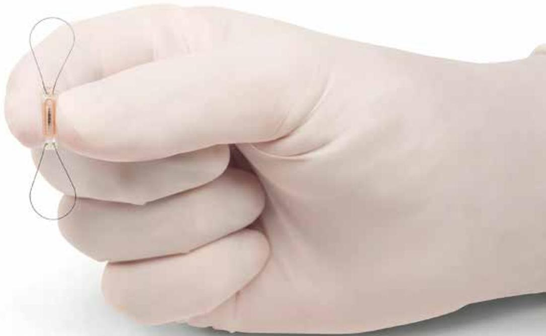
Der Miniüberwachungssensor, der den Druck in den großen Lungengefäßen kontinuierlich misst, ist so klein wie eine Büroklammer.
