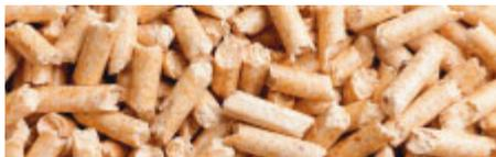
**Pelletkessel sind die komfortabelste und emissionsärmste Form, mit Holz zu heizen. Durch die Schütffähigkeit der rund 5 mm im Durchmesser und 20 mm in der Länge messenden Pellets haben Pelletheizungen den Komfort einer Erdöl- oder Erdgasheizung erreicht. Die Pellets selbst sind nichts anderes als gepresste Sägespäne. Zwei Kilogramm Pellets ersetzen einen Liter Öl oder einen Kubikmeter Erdgas. Alles läuft bei einer Pelletheizung vollautomatisch ab.**
