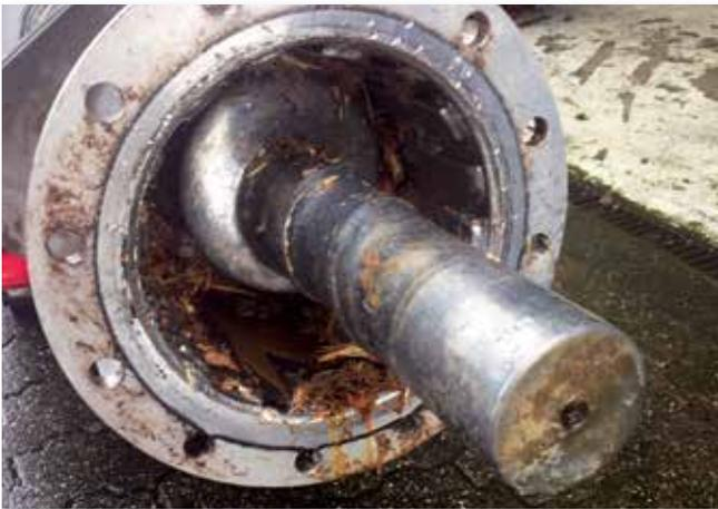
Auf dem **KLÄRWERK RATINGEN** bedurfte es der Erneuerung der Förderschnecke bei einer der beiden Rechengutwaschpressen, da die Wendel weitestgehend abgenutzt war.
