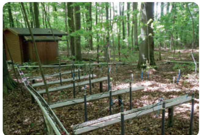
Messung der Bodenwasserspannung mit Tensiometern auf der Level-II-Fläche Schwaney
