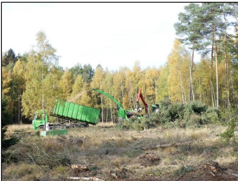
Abb. 50: Räumung des Kronenschnitts und Häckseln zum Abtransport und der weiteren Verarbeitung (Foto: © Bezirksregierung Münster)
