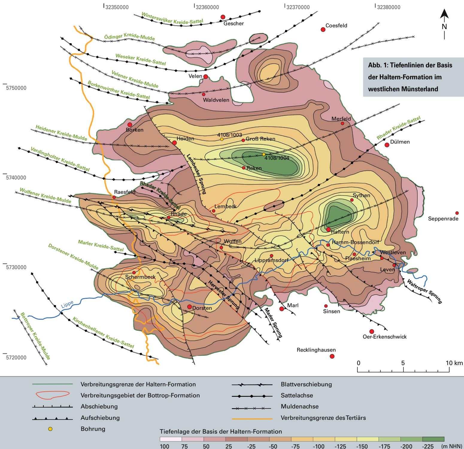
Die Liegendgrenze der Haltern-Formation wird durch die Sandmergelsteine der Recklinghausen-Formation gebildet. Sie ist in Bohrprofilen insbesondere mittels bohrlochgeophysikalischer Messungen recht gut erkennbar, teilweise aber auch fließend. Laterale Faziesübergänge können gleichfalls auftreten (Hiss 2006b).
